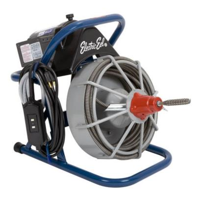
Conçu spécifiquement pour l'industrie de la location, le modèle E possède plusieurs caractéristiques uniques telles qu'un tambour intérieur en acier, une cage revêtue d'époxy, des enrouleurs de cordon et une barre arrière pour la protection du moteur. L'unité peut contenir un câble galvanisé jusqu'à 75 pieds de 3/8? ou 1/2? de diamètre . Nettoie les conduites de 1 1/4? – 3? de diamètre. Un chariot à 2 roues en option est disponible pour faciliter le transport.
