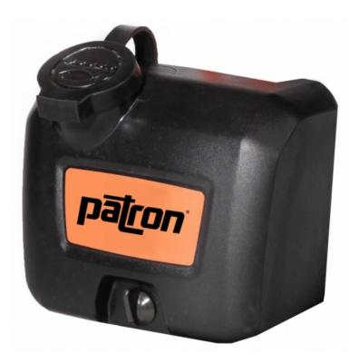
Ce réservoir d'eau est conçu pour être utilisé avec les compacteurs à plaque Patron FP60. Lors du compactage d'asphalte chaud, un apport constant d'eau froide est nécessaire en surface pour éviter que l'asphalte chaud ne colle à la plaque froide du compacteur. Les réservoirs d'eau sont également idéaux pour les applications très poussiéreuses.
